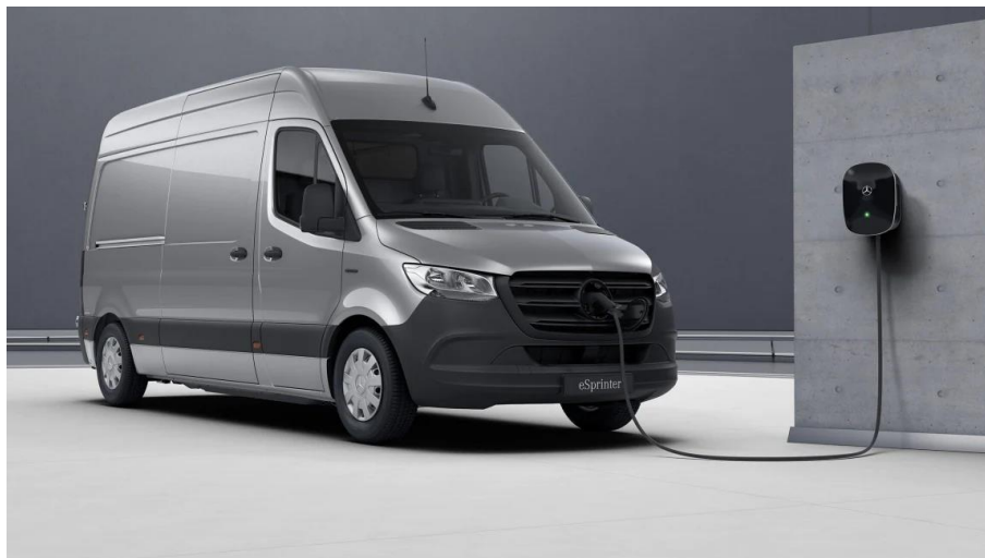
Εικόνα 3-9 Το Mercedes-Benz eSprinter Van το οποίο πωλείται δύο διαφορετικές εκδόσεις με μπαταρία χωρητικότητας από 35 και 47 kWh, χρόνο φόρτισης με AC 6 ώρες και 8 ώρες αντίστοιχα και αυτονομία έως 120 και 168 χ.μ. (Mercedes-Benz, 2021)
