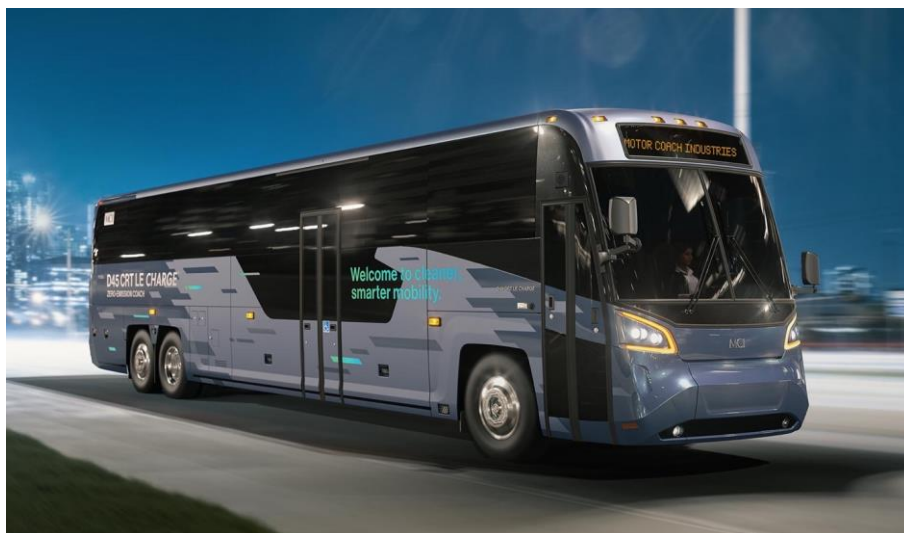
Εικόνα 3-12: Το D45 CRT LE CHARGE της MCI με μπαταρία 389 kWh και εύρος 300 χμ. χωρίς επαναφόρτιση (MCI, 2021)
