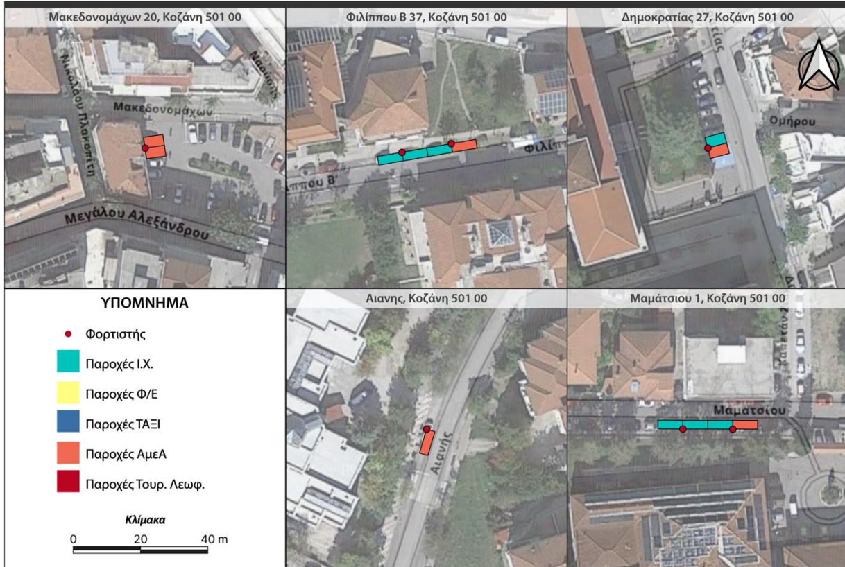
Εικόνα 3-7: Σταθμοί Φόρτισης Η/Ο ΑμεΑ
