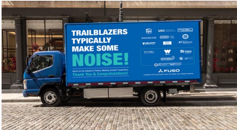
Εικόνα 3-10 Το Mitsubishi FUSO eCANTER με μπαταρία χωρητικότητας 82,5 kWh χρόνο φόρτισης 8 ώρες με AC και εύρος χωρίς επαναφόρτιση 130 χλμ.
